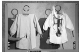
衣類の着火実験。左の防災製品は着火点が焦げる程度なのに比べ、右の普通の衣類は燃え広がっています
